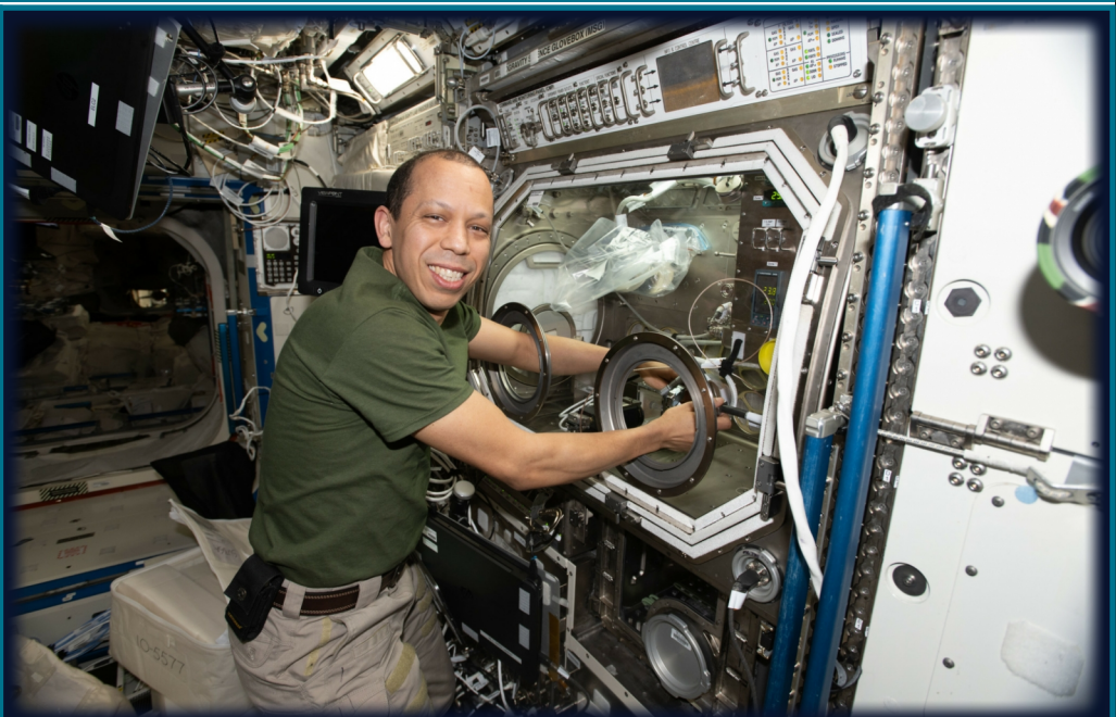
NASA-Astronaut Chris Williams ersetzt Probenhardware zur Halbleiterkristall-Forschung in der Microgravity Science Glovebox im Destiny-Labormodul der ISS. Das Wachstum von Kristallen in Schwerelosigkeit könnte zukünftig eine großflächige
